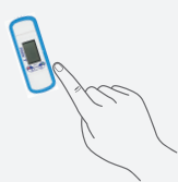
Attivazione data logger
